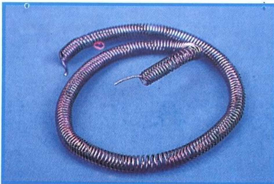
Figura 35 b - Exemplo de Mau Condutor (níquel-cromo).
