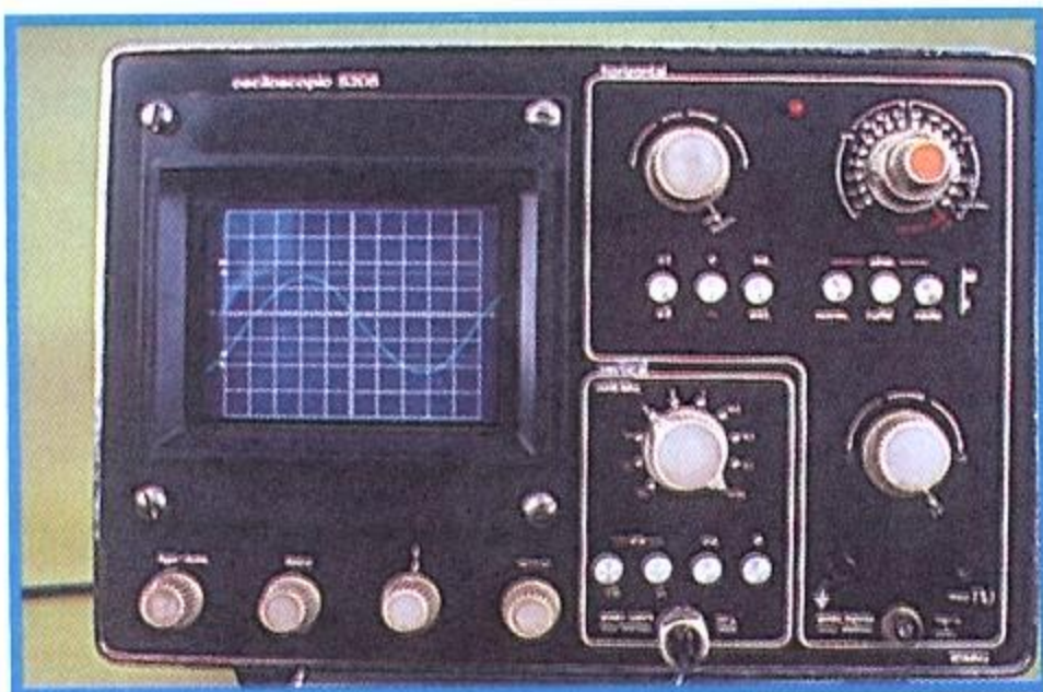
Figura 32 - Corrente alternada (um ciclo).
