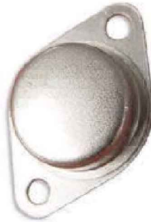
Figura 2 - Transistor de potência encontrado em sistemas de ignição.
