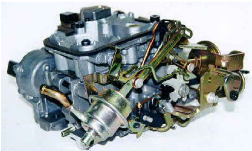
Figura 6 – Carburador moderno sofisticado, totalmente mecânico
