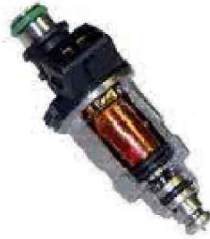
Figura 8 - Um injetor de um sistema de injeção eletrônica.
