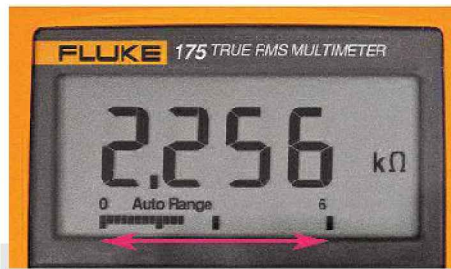
Figura 12 – A escala bargraph de um multímetro digital
