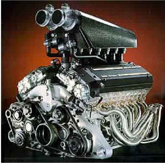
Figura 7 - Motor BMW de 12 cilindros de 618 hp
