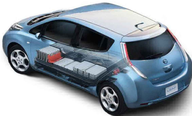
Figura 16 - Localização dos 48 módulos de bateria que fornecem 80 kW de potência ao motor no Nissan Leaf.
