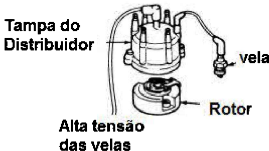
Figura 23 – Quando o rotor gira ele faz contato com os terminais dos fios que vão as velas situados na tampa
