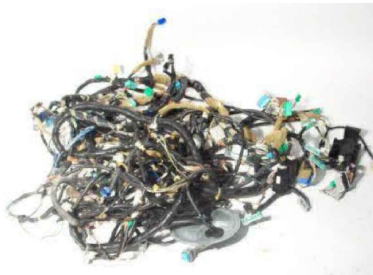
Figura 7 – Quantidade de fios retirada de uma instalação elétrica de carro comum
