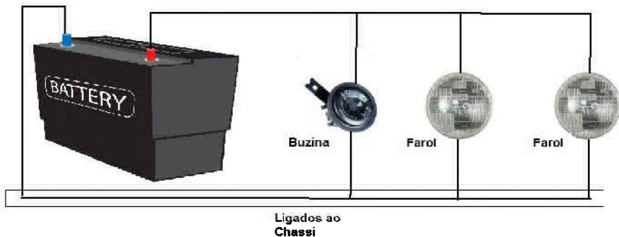
Figura 5 – Dispositivos alimentados pela bateria ligados em paralelo
