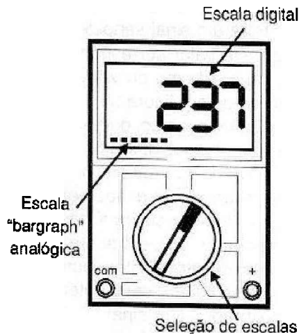
Figura 18 – A escala analógica de um multímetro digital
