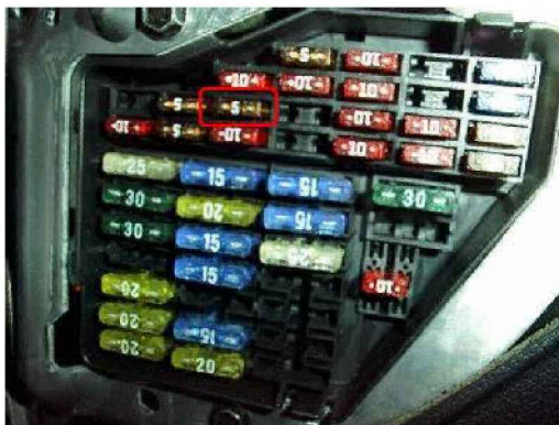
Figura 10 – A caixa de fusíveis de um automóvel
