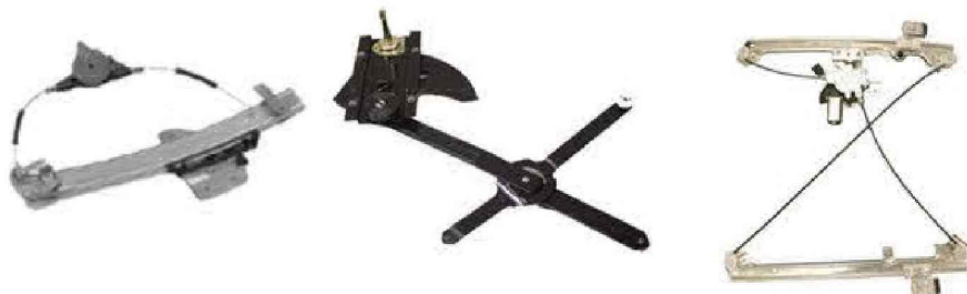
Figura 13 – sistemas mecânicos de acionamento de vidros
