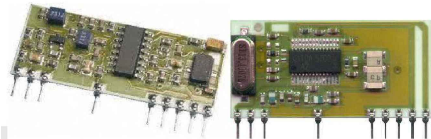
Figura 29 – Módulos de 433,92 MHz usados em controles remotos
