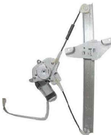
Figura 14 – Motor e sistema de acionamento de um vidro elétrico
