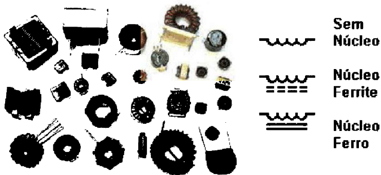
Figura 3—Bobinas ou indutores — aspectos e símbolos
