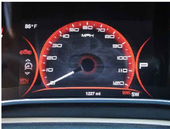
Figura 9 – Velocímetro digital emulado de modo a ter um ponteiro virtual que se desloca numa escala
