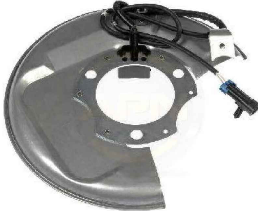
Figura 7 – Sensor indutivo que sensoria o movimento da roda
