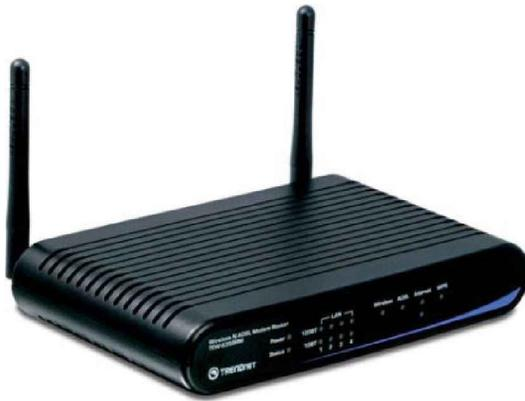
Figura 162 – Modem sem fio
