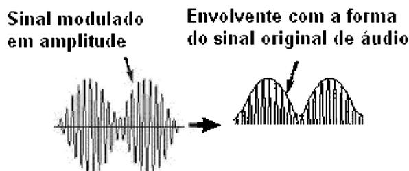
Figura 100 – Detecção do sinal modulado em amplitude
