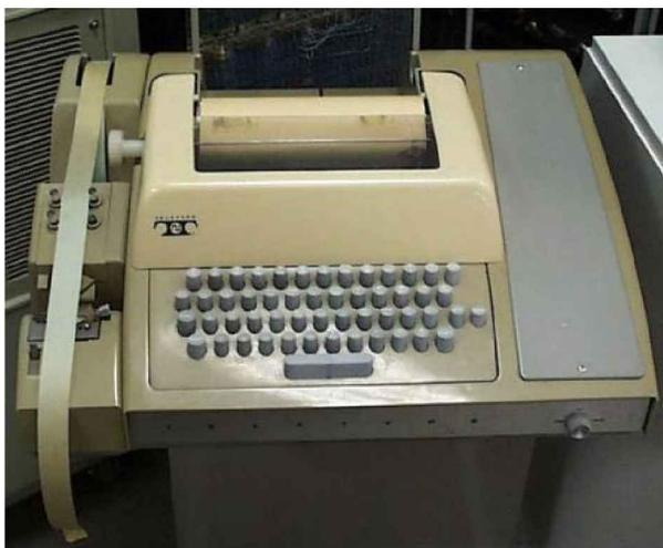
Figura 163 – Uma antiga máquina de teletipo. Veja a fita perfurada do lado esquerdo.
