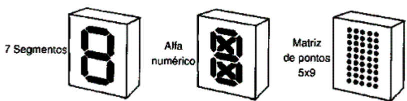
Figura 134 – Displays simples numéricos e alfa numéricos
