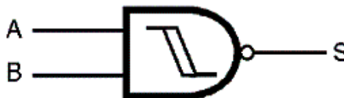
Figura 11 – A função NAND disparadora do 4093 (CMOS)
