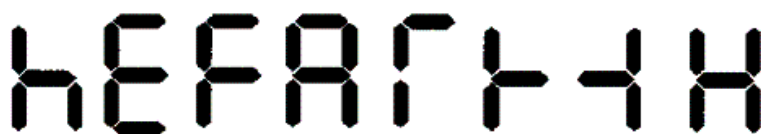
Figura 136 – Outros símbolos que podem ser apresentados num display de 7 segmentos.
