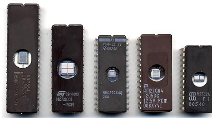
Figura 156 - EPROMs comuns com suas janelas de quartzo expondo o chip
