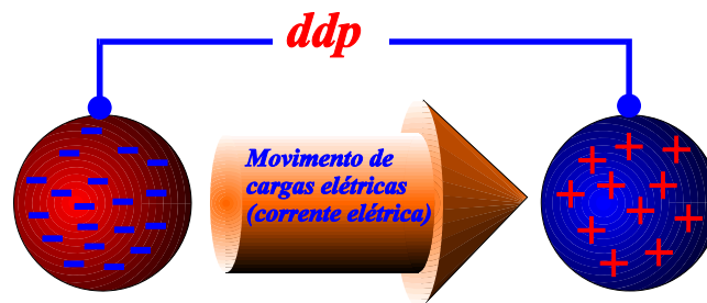
Fig.1 Origem da corrente elétrica.
