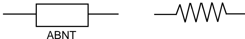
Fig.2 Símbolos utilizados para representar um resistor.
