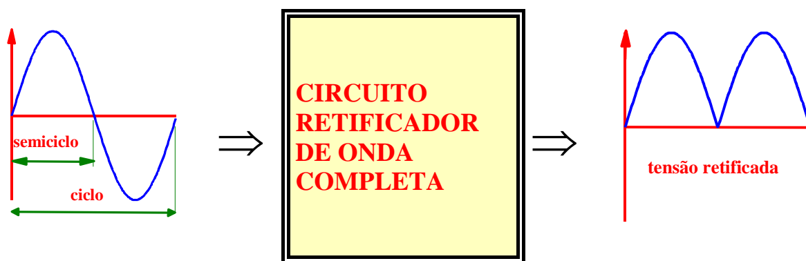
Fig.1 Diagrama ilustrando o princípio de operação do circuito retificador de onda completa.
