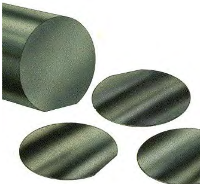
Fig.3 Aspecto das bolachas de silício após corte e polimento.
