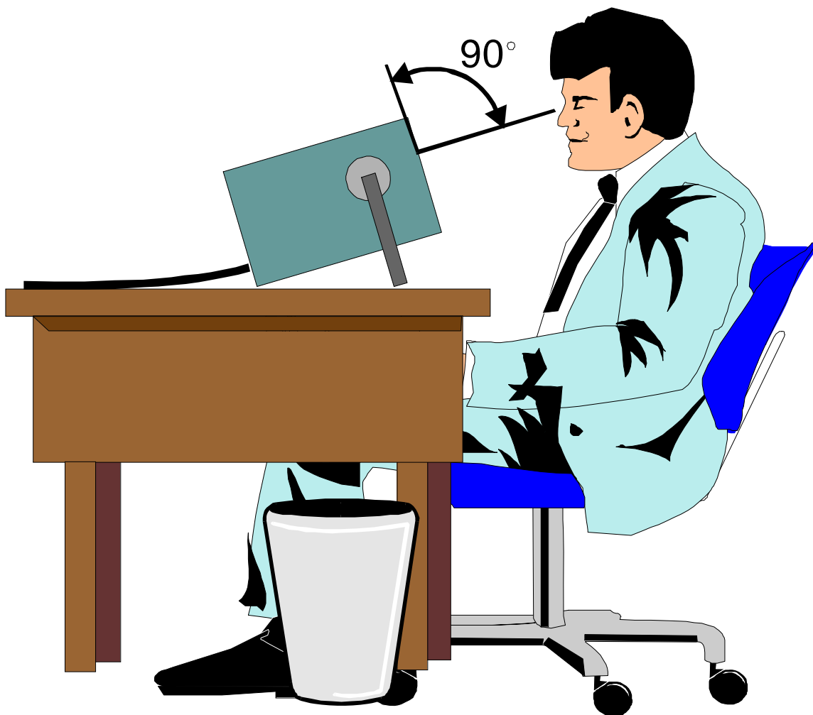
Fig.2 Posição correta do operador para a realização do ajuste do traço na tela.
