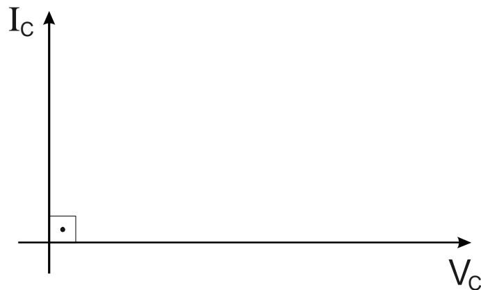
Fig.10 Representação fasorial da defasagem entre tensão e corrente no capacitor.
