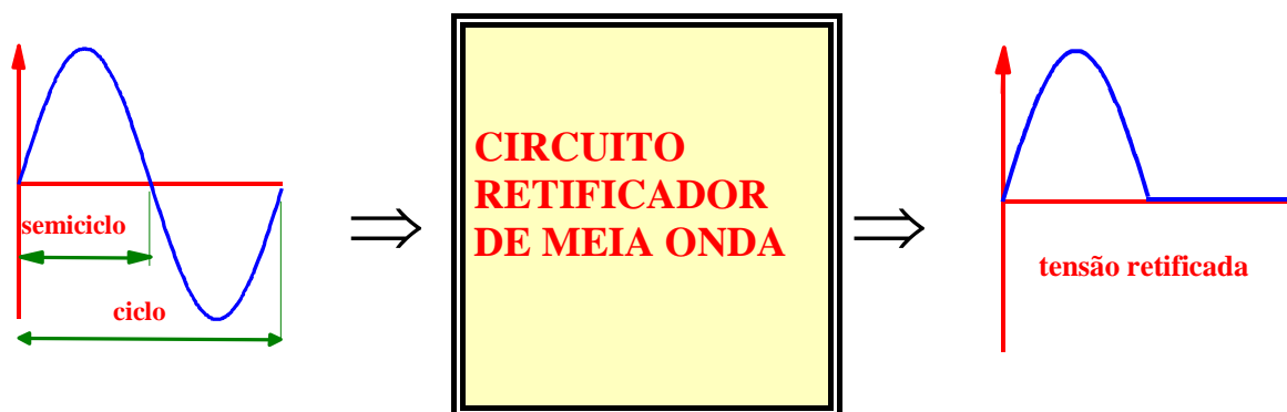
Fig.1 Diagrama ilustrando o princípio de operação do circuito retificador de meia onda.
