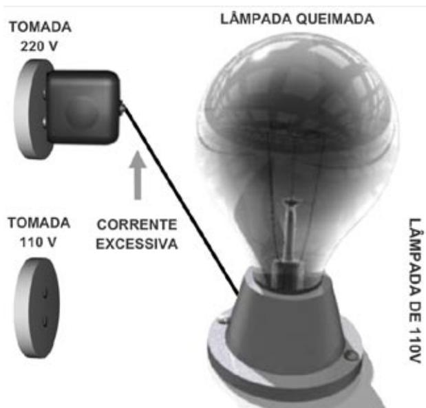
Figura 38 – Excesso de corrente queimando uma lâmpada
