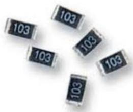
Figura 52 – Resistores SMD de 10k ohms.
