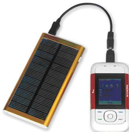
Figura 90 – Carregador solar de bateria de celular.
