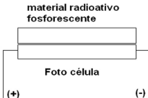
Figura 93 - Uma célula com material fosforescente
