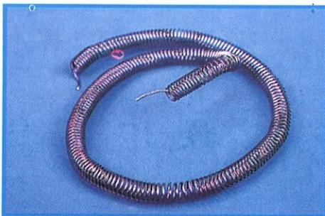
Figura 35 b - Exemplo de Mau Condutor (níquel-cromo).
