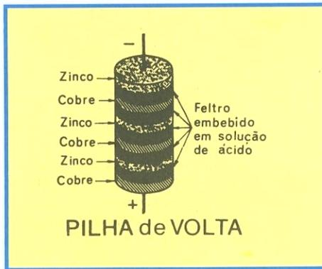
Figura 45 - Pilha de Volta.
