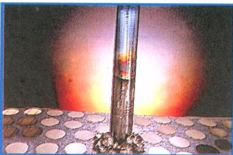
Figura 35 c - Exemplo de Semicondutor (barra de silício).
