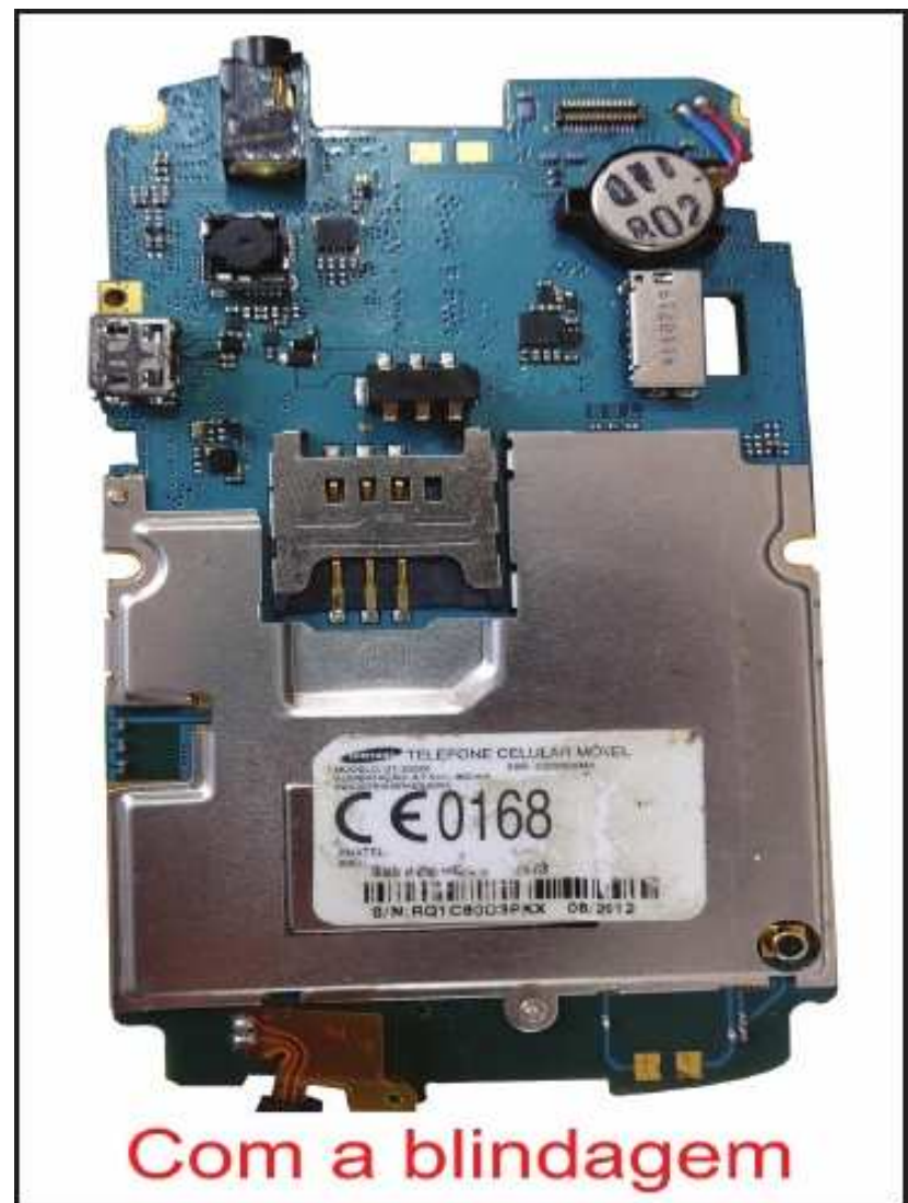
Figura 48 E - Placa com blindagem electrostática para evitar interferências.
