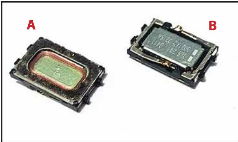
Figura 45 - Exemplos de altofalantes, ou capsulas receptoras, como se dizia antigamente.
