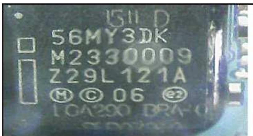
Figura 31 - Memórias soldadas por processo BGA em uma placa de celular.
