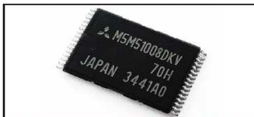
Figura 30 - Memória RAM fabricada pela Mitsubishi.
