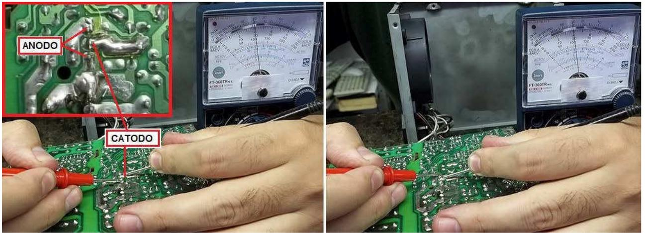
Figura 35 – Teste de um dos diodos duplos de potência da fonte.
