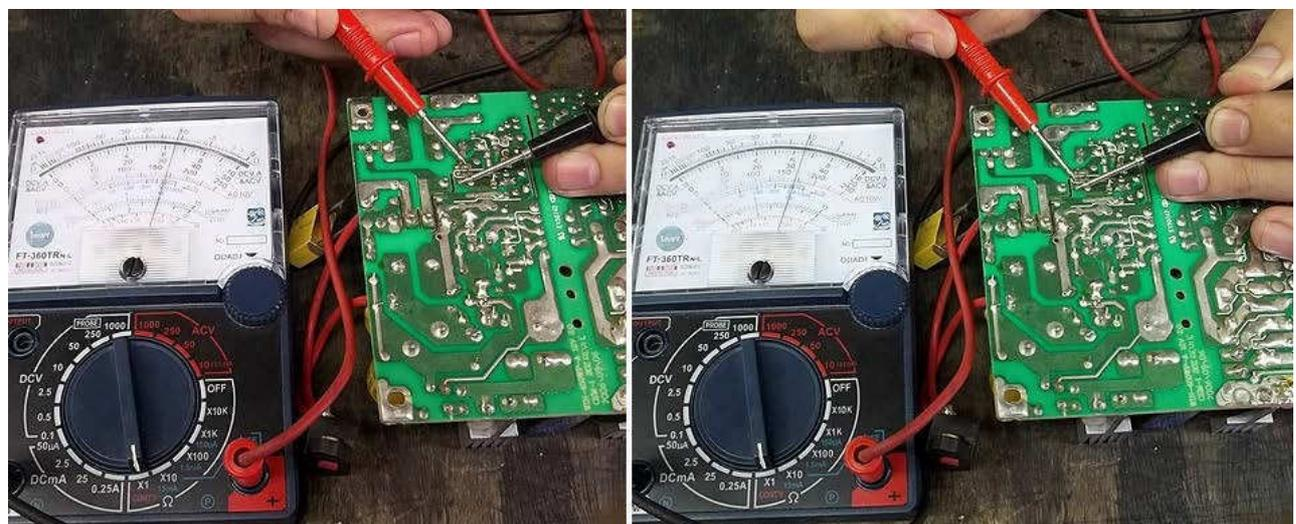
Figura 44 – Teste do transistor chaveador da fonte stand by.
