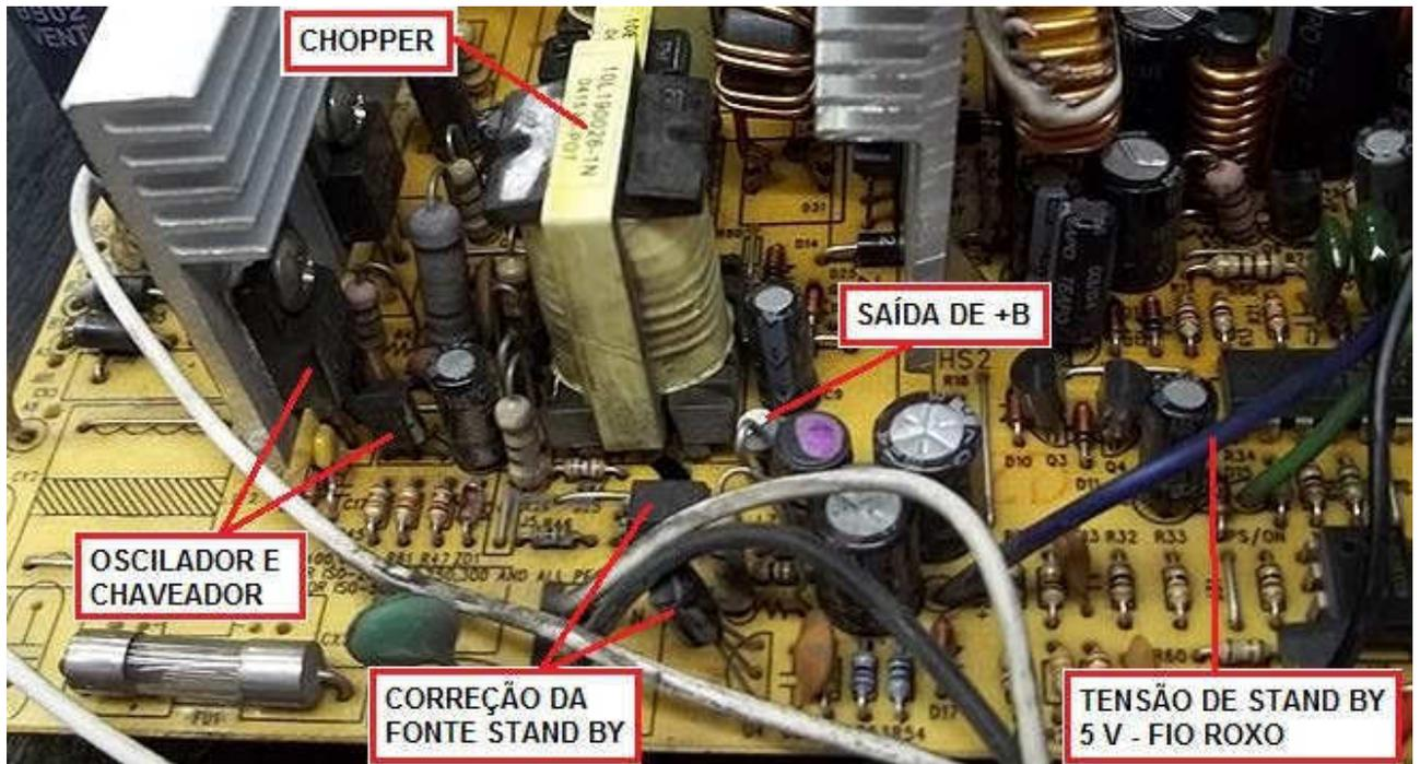
Figura 17 – Circuito de stand by de uma fonte de PC visto com detalhes.
