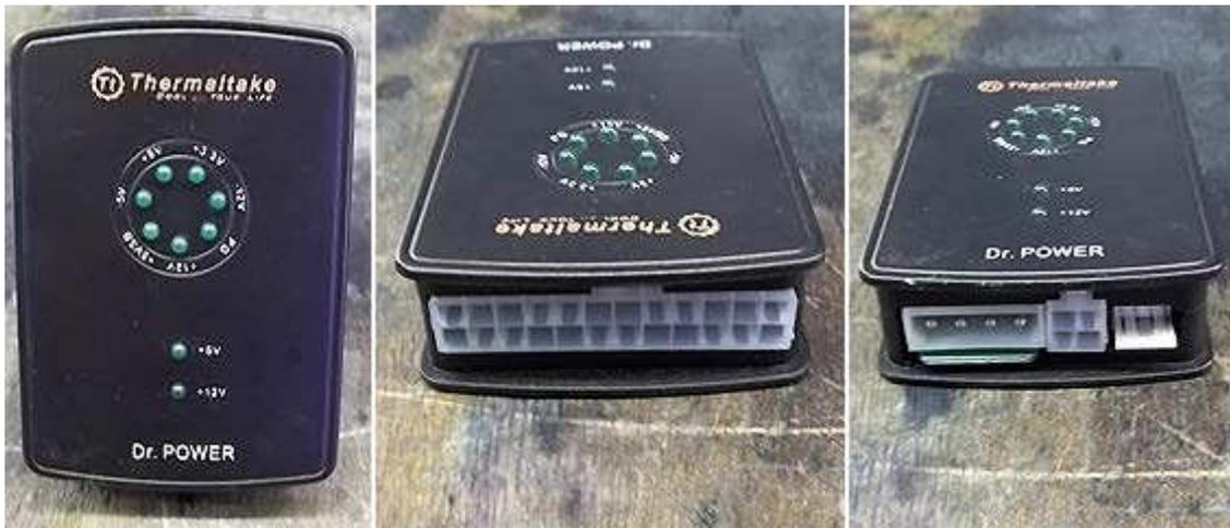
FIGURA 2 – Testador de fonte de PC.
