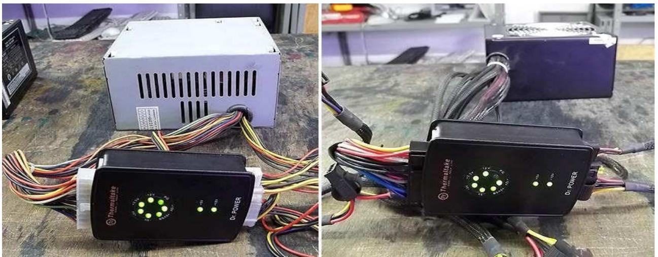
Figura 8 – Testando duas fontes com um testador para fontes de PC.
