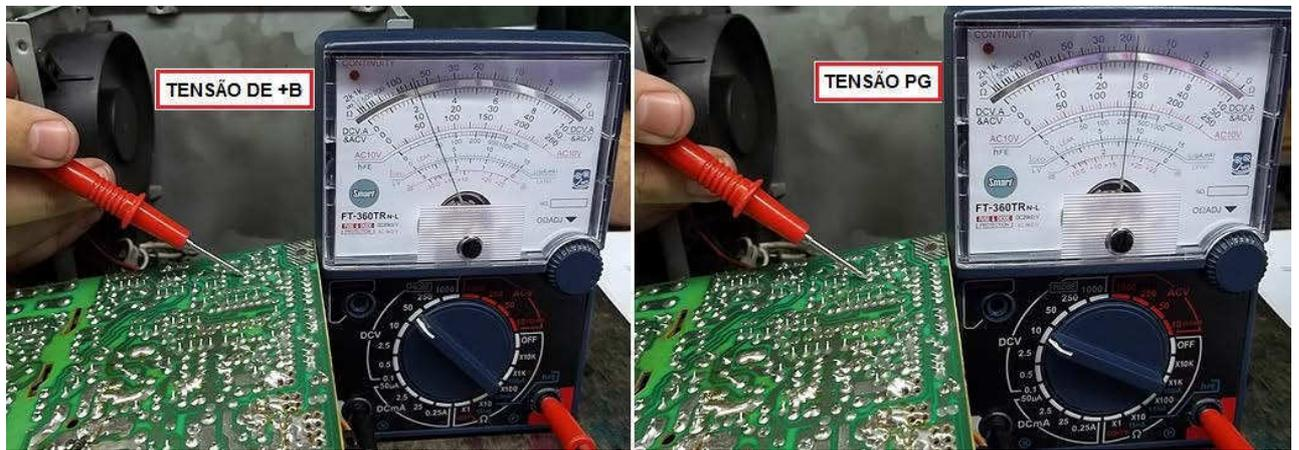
Figura 40 – Teste do +B e tensão PG no CI monitor da fonte.
