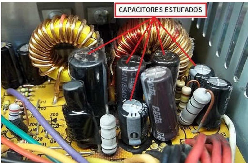
Figura 21 – Detalhe de uma fonte com os capacitores de filtro de saída estufados.
