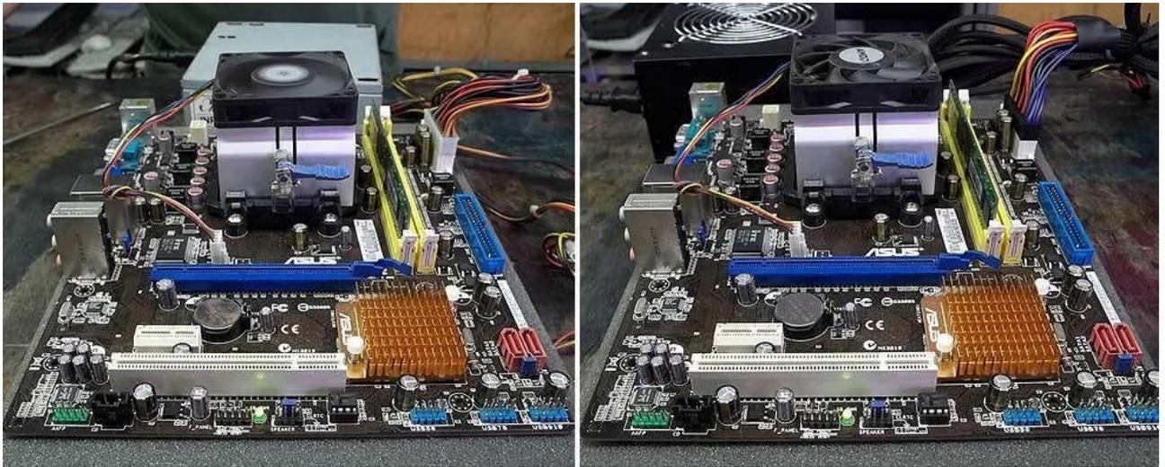
Figura 14 – À esquerda uma fonte boa e à direita uma com defeito alimentando a mesma placa mãe.
