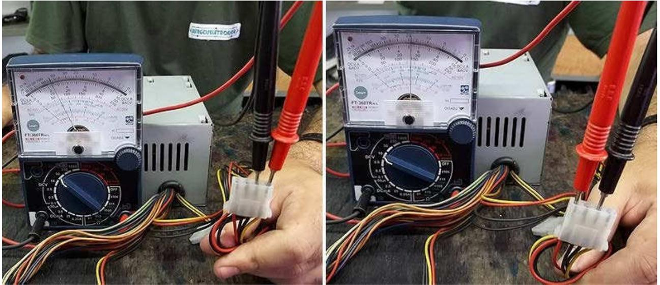
Figura 10 – Medindo as tensões de 5 e 12 V no conector do HD ou gravador de DVD.
