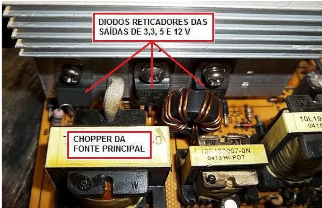
Figura 19 – Diodos retificadores de potência das saídas de 3,3, 5 e 12 V.
