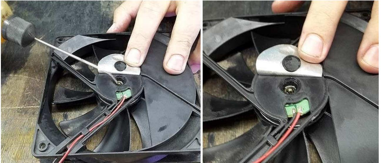
Figura 49 – Colocando óleo de máquina no ventilador da fonte.
