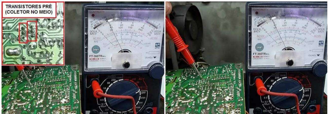
Figura 39 – Medindo tensão AC no coletor dos transistores pré usando o encaixe “OUT PUT”.
