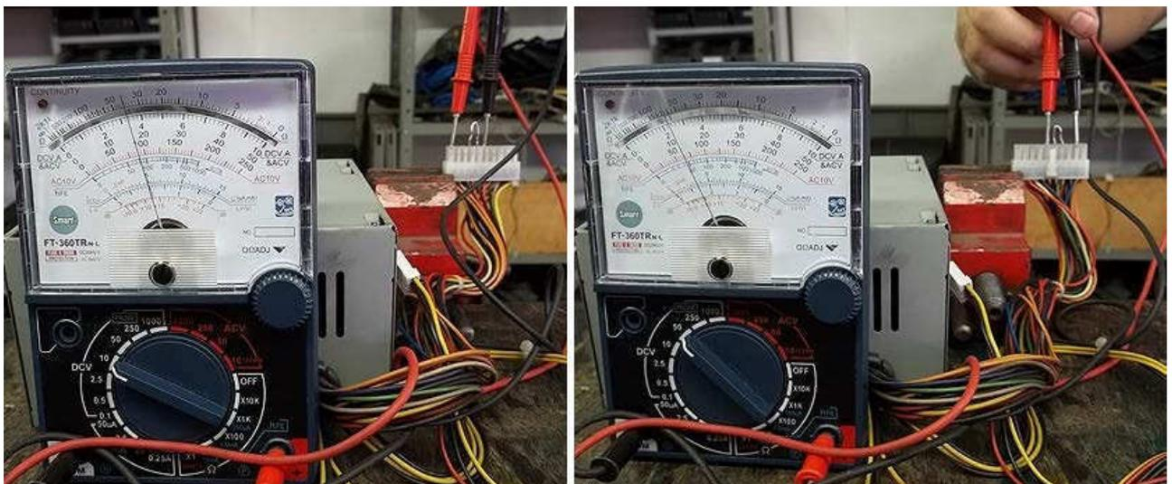
Figura 12 – Medindo a tensão de 3,3 V (à esquerda) e a de - 12 V (à direita).
