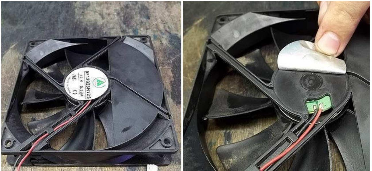
Figura 48 – Retirando a etiqueta da parte interna do ventilador.
