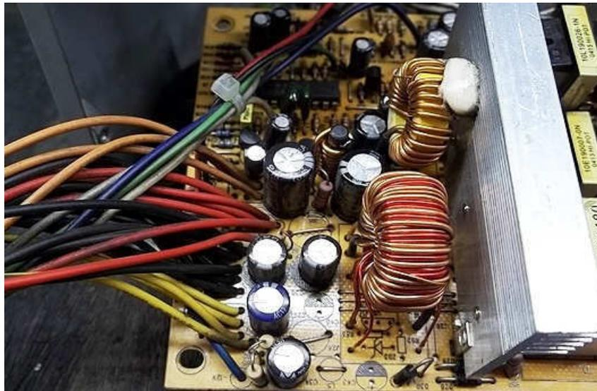
Figura 20 – Eletrolíticos e bobinas de filtro nas saídas da fonte de PC.
