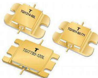
Figura 12 – Transistores de GaN de potência capazes de operar em frequências acima de 10 GHz.
