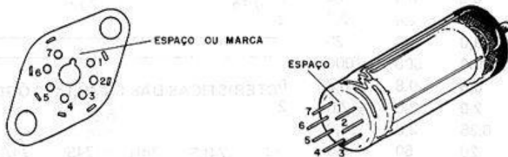
Figura 9 – Pinagem de válvulas
