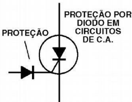
Figura 15 – Usando um diodo de proteção
