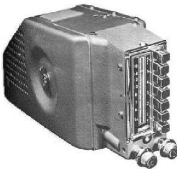
Figura 19 – Rádios de carro existem desde 1922. Na foto dois curiosos modelos antigos obtidos na Internet usando válvulas e vibradores...
