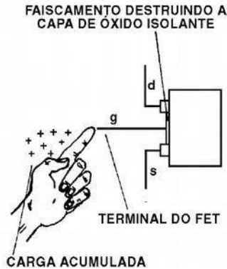
Figura 10 – Descargas estáticas podem inutilizar o componente.
