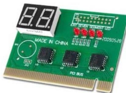
Figura 11- Placa de diagnóstico com indicação em binário (4 LEDs)
