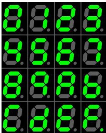
Figura 17 – Displays de 7 segmentos apresentando numeração em hexadecimal.
