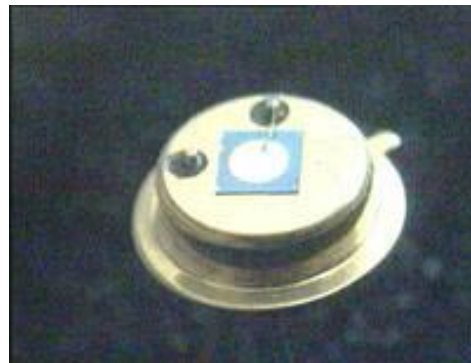
Figura 324 - Diodo sensor de radiação nuclear
