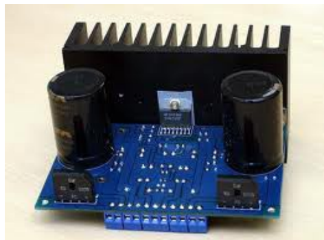
Figura 467 - Montagem de amplificador com o LM4765
