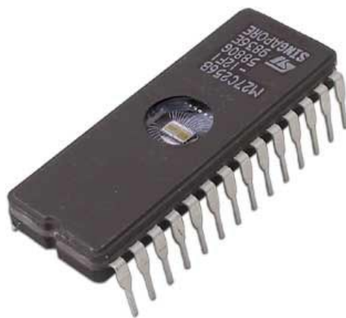
Figura 374 - Invólucro com janela de quartzo (uma memória EPROM)
