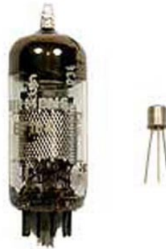
Figura 82 – Válvula comparada a um transistor de uso geral
