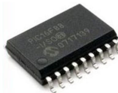
Figura 384 - Invólucro típico para circuito integrado
