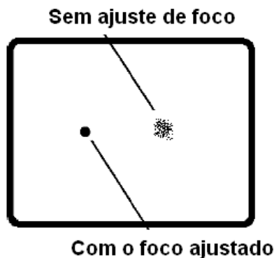
Figura 345 - Ponto de imagem na tela de fósforo
