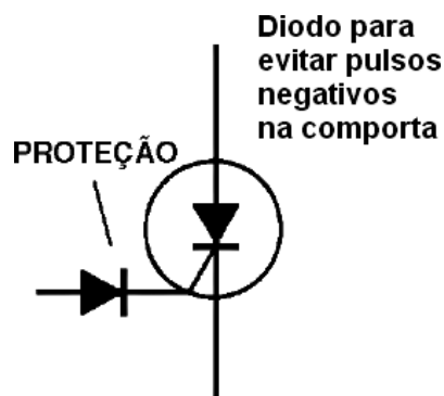
Figura 194 – Protegendo o SCR com um diodo
