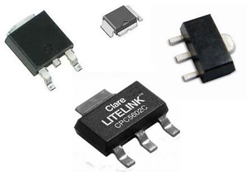
Figura 383 - Transistores SMD de potência
