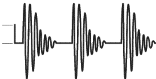
Figura 235 – Forma de onda de um oscilador de bloqueio
