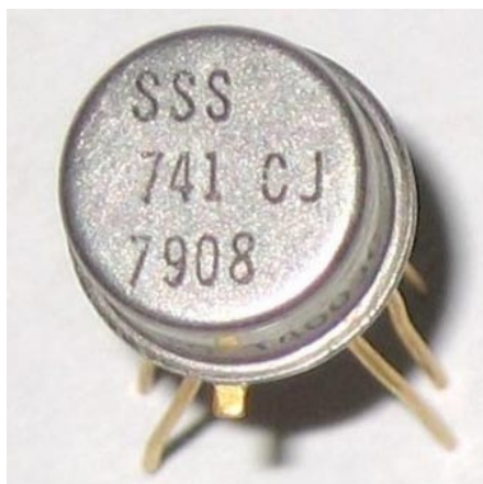
Figura 397 - Amplificador operacional em invólucro TO-5 antigo
