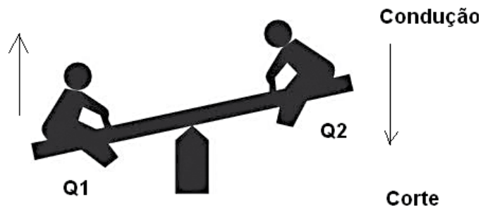
Figura 246 – Podemos comparar o funcionamento do astável a uma gangorra
