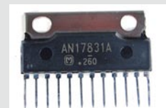
Figura A- Um circuito integrado que contém todos os componentes de um amplificador de áudio, como o que estudamos
