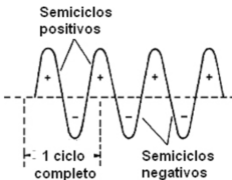
Figura 41 – A tensão alternada da rede de energia
