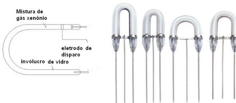
Figura 338 - Lâmpada de xenônio - estrutura e aspectos
