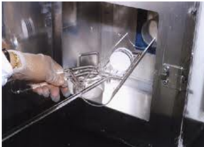
Figura 366 - colocando wafers num forno de difusão
