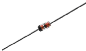
Figura 15 – Um diodo 1N4148
