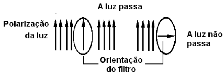
Figura 332 - A ação do polarizador
