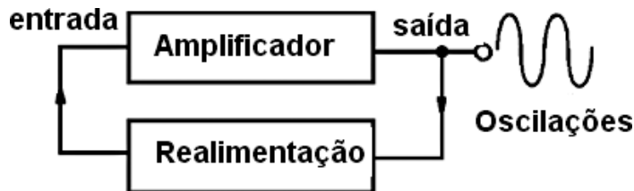
Figura 224 – Um oscilador nada mais é do que um amplificador com um circuito de realimentação
