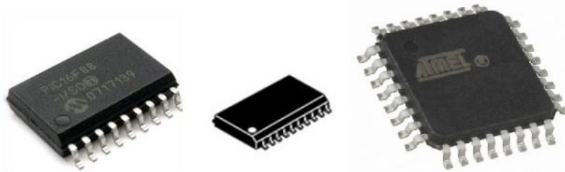
Figura 376 - Invólucros de CIs para montagem em superfície
