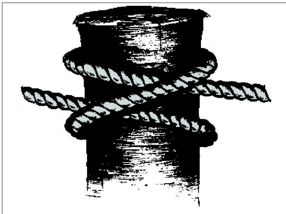
Fig 4-18. Nó de porco ou de barqueiro (para ancoragem)
