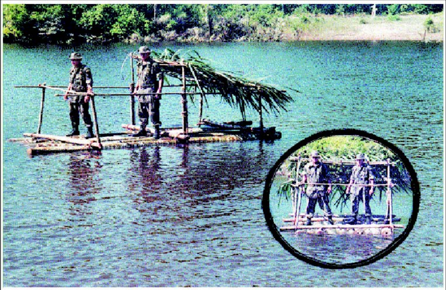
Fig 4-36. Jangada em condições de navegar
