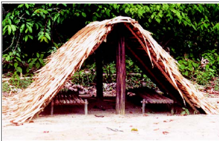
Fig 5-4. Tapiri duas águas (com duas camas de galhos e cipós)
